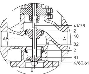
**Конструкция с распределителем, начиная с DN 80**
