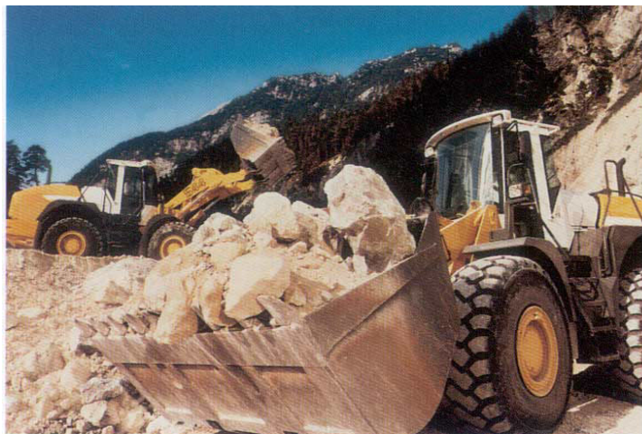
Ładowarka kołowa z układem stabilizacji i płytą z hydroakumulatorami.
