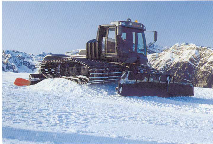
Hydropneumatyczne zawieszenie i napinanie łańcuch w ratraku.
