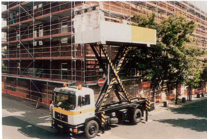
Podnośnik nożycowy z automatycznym poziomowaniem podpór.
